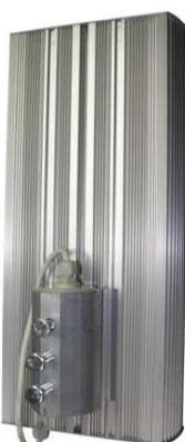
Блок питания: имеет соответствие ЭМС в диапазоне от 9 кГц до 30МГц , стойкость к микросекундным импульсам большой энергии 2 кВ (L-N), 4 кВ (L- PE, N-PE), гальваническую изоляцию, пульсации <1%, защиту от 380 V, рабочую Тa -40. +50C<sup>0</sup> Тип крепления: консольное на трубу, на скобе
