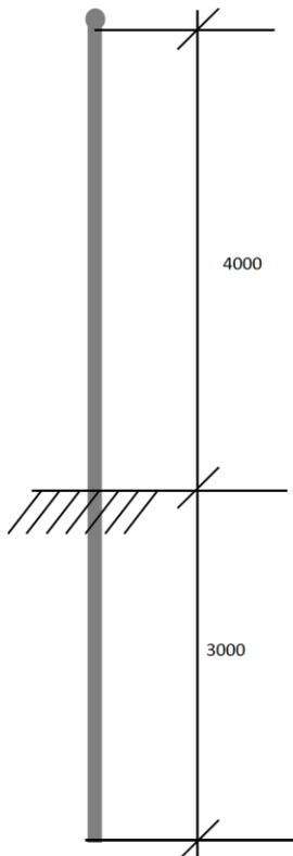
Стойки выполнены из металла диаметром 76 мм. Высота стоек 7 м. (3 м. под землей, 4 м. над землей) окончание трубы – расплющенный квадрат и декоративный элемент – шар диаметром 80 мм.). Наличие двух натяжных роликов с металлическим тросом диаметром 5-6 мм. Ролики расположены на отметках 2,5 м и 4 м. над землей. Окраска конструкции серой грунтовой краской.
