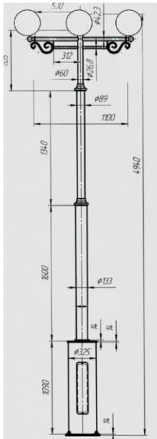
Стойки выполнены из металла. Окраска конструкции черной грунтовой краской. Светильник парковый светодиодный диаметром 300 мм. (6 шт.)
