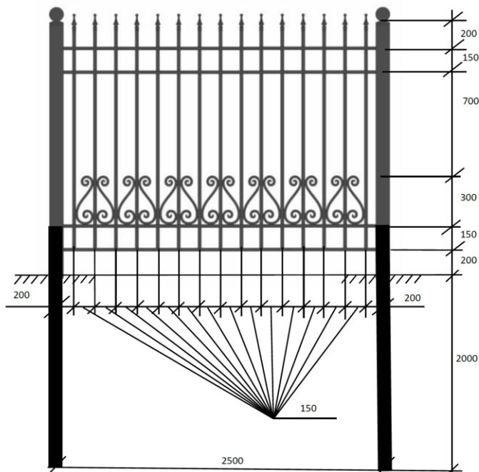
Ограждение общей длиной 57 м/погонных, включая ворота. Размер секции 2420x1500 мм. Ограждение состоит из следующих материалов: столбы - труба квадрат 80x80x3 мм, наполнение - продольная труба квадрат 30x30x1,5 мм., поперечная труба квадрат 20x20x1.5 мм, рисунок – квадрат 15x15x1 мм, окончания элементов рисунка развальцованы.. Окончания столбов – квадрат с декоративным элементом – шар диаметром 80 мм. Нижняя часть столбов глушится металлической пластиной 100x100x4 мм.
